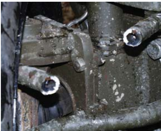
Rys.5. Pęknięty drążek kierowniczy Fig.5. Broken steering bar
