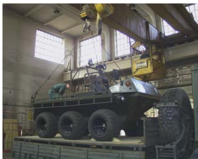
Rys. 7 Załadunek pojazdu z użyciem suwnicy dźwigowej Fig. Vehicle during loading with crane
