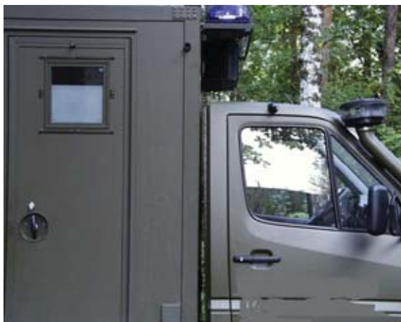
Rys.4. Odształcenie ramy spowodowało uderzenie kabiny o przewożony kontener Fig.4. Frame deform caused hit on cabin with container
